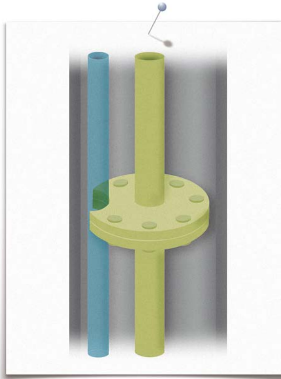
Figura 5.1 – Exemple d'una canonada piezomètrica dintre d'un pou equipat.
