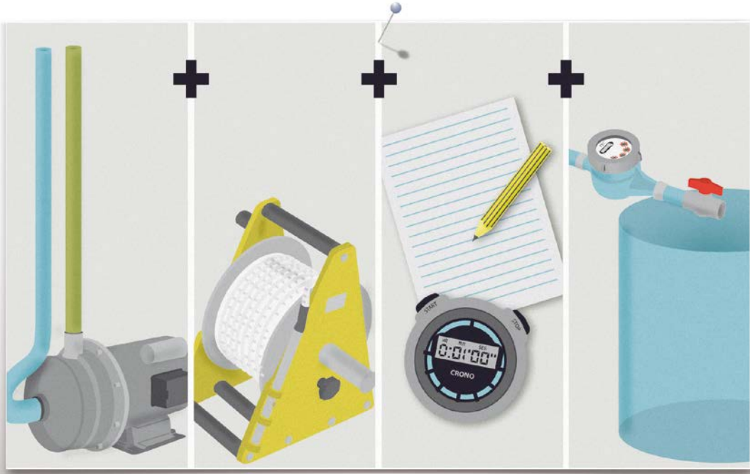
Figura 4.6 – Material necessari o recomanable per a l'assaig de bombament: (Bomba, sonda de nivell acústica, cronòmetre, paper i llapis, comptador i aixeta.)
