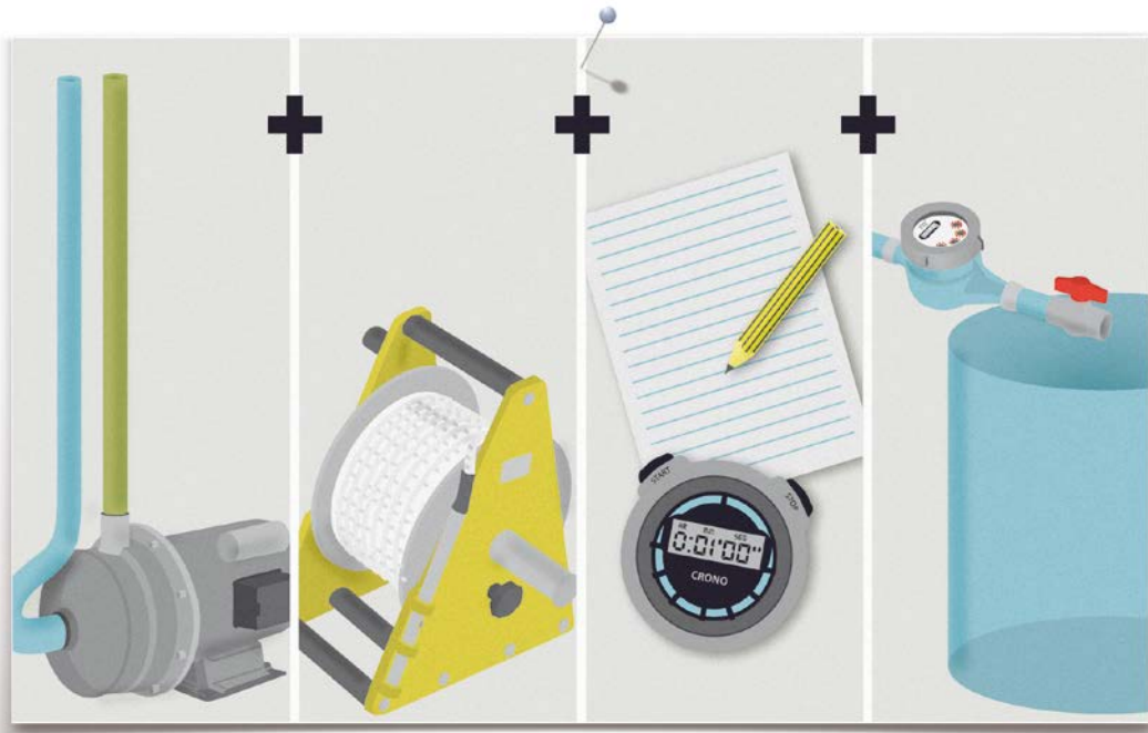
Figura 5.5 – Material necessari o recomanable per a l'assaig de bombament: (Bomba, sonda de nivell acústica, cronòmetre, paper i llapis, comptador i aixeta.)
