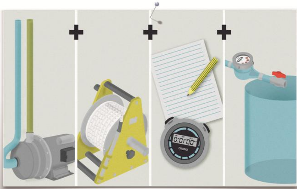
Figura 5.5 - Material necesario o recomendable para el ensayo de bombeo: (Bomba, sonda de nivel acústica, cronómetro, papel y lápiz, contador y grifo.)
