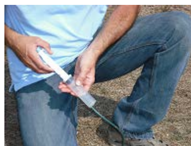
Extracción de solución del suelo en PC2
